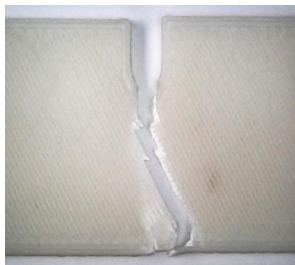
Fig. 3. Propagation de la fissure selon l'angle le plus grand pour la configuration (2) (cas : 30°/60°).
