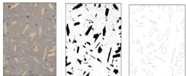
a) Image d'origine (scannée en couleur) b) Image en cours de traitement par ImageJ® c) Image finale
