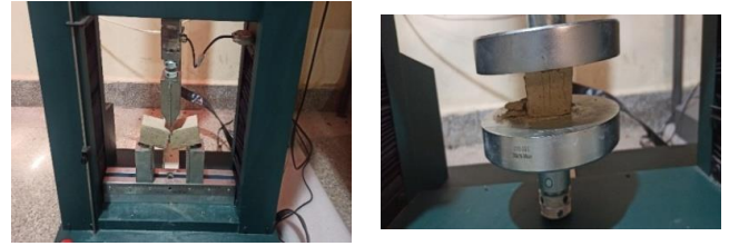
Fig. 2 : Banc H10KL de mesure des résistances à la compression et flexion.
