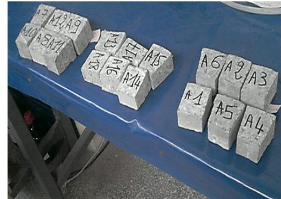
Fig. 2. Préparation des échantillons en béton pour les essais d'immersion dans l' H_2SO_4
