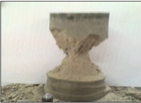
Figure 5. Eprouvette de sable laitier écrasée à 28 jours
