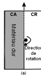
Figure 3 : la position des plaques et le sens de rotation de l'outil lors le soudage.
