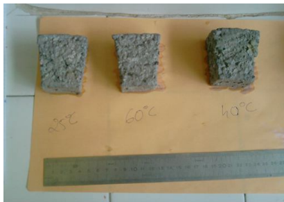
Fig. 4. Observations visuelles des dégradations du béton vieilli environ 45 heures
