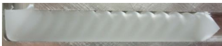
Figure 3. Images d'une éprouvette après ECAE, extrudée à une vitesse de 45 mm/min et sans contre pression.
