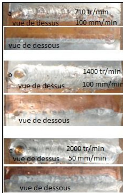
Figure 4 : Morphologies de surface des joints d'Al-Cu par FSW sous un excentrage de pion de 2mm pour des vitesses de rotation de (a) 720 tr/mn, (b) 1400 tr/mn, (c) 2000 tr/mn.
