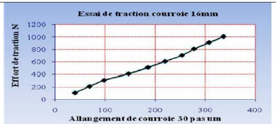
Figure 4. Variation de l'allongement en fonction de l'effort de traction (courroie 16 mm).
