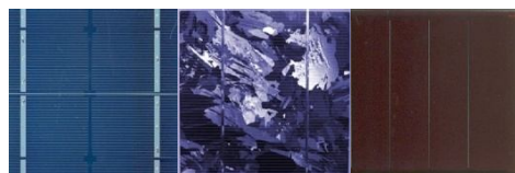
Figure 2.1 : De gauche à droite : cellule photovoltaïque monocristalline, polycristalline et amorphe.
