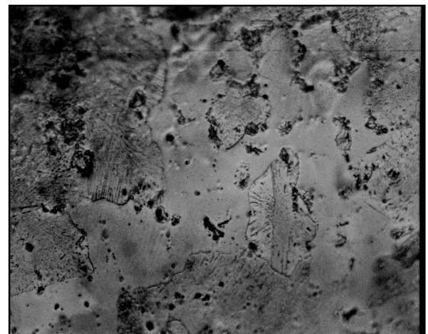
Fig6: alliage Pb2%Cd0,08%Sr0,15%Ag, brut de coulée , vieilli 3 mois à la température 80°C. Visualisation de la précipitation discontinue lamellaire
