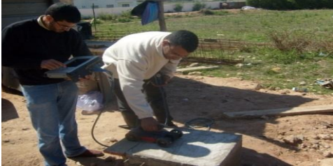
Figure. 3: Principe simplifié de l'auscultation radar d'un élément en béton armé.
