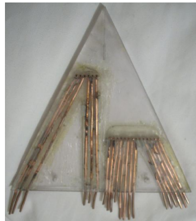
Figure 1 : Aile delta avec prises de pression Les prises de pression sont repérées par leurs coordonnées cartésiennes (x,y) avec l'origine des axes pris au sommet de
