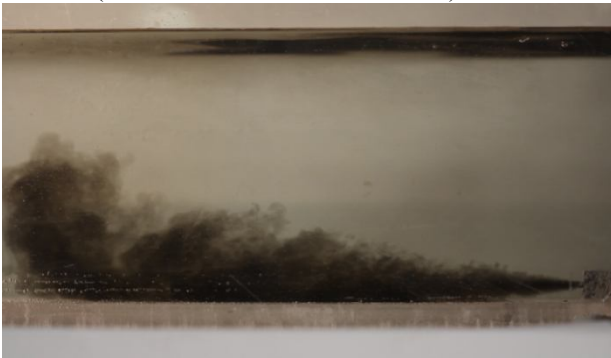
Figure 3. Photo d'expérience du panache forcé horizontal pariétal
