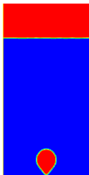
Fig.10 : Fin du détachement de la bulle
