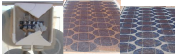
(d) boîte de jonction cassé (e) Jaunissement de EVA (f) Décoloration des cellules
